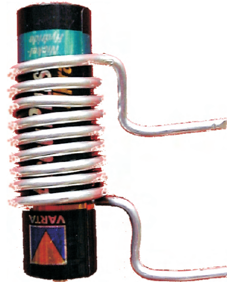
Spule mit verschwenkten Anschlüssen (zu Versuch 9)
